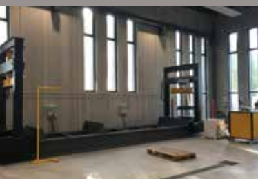
Banc pour essai de flexion sur poutre 2x300 kN
